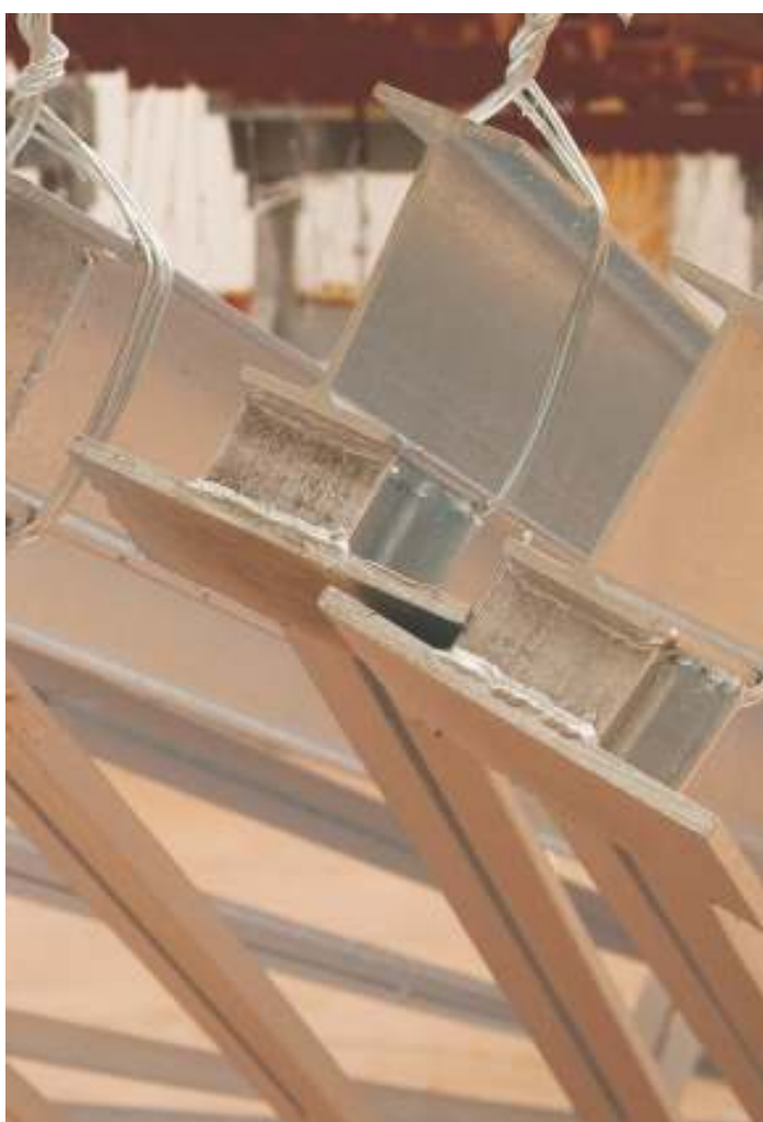
Dopo il trattamento con l'applicazione dello strato di zinco a caldo
